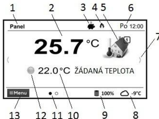
Obr. 3: Hlavní obrazovka termostatu Room Control Radio TOUCH
