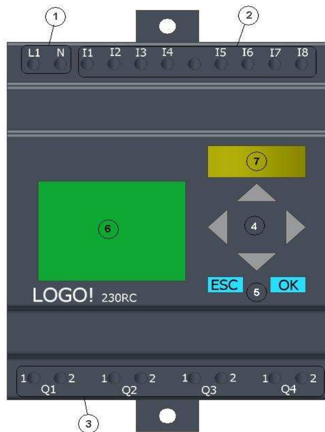
Obr. 5 čelní pohled na řídicí jednotku LOGO! 230RC
