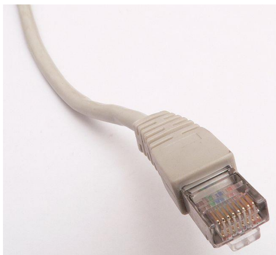
Kabel s koncovkou RJ-45
